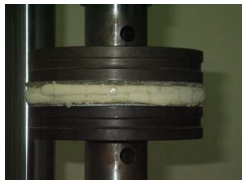
Rys. 20. Sposób niszczenia panelu energochłonnego w postaci czterech tulejek kompozytowych z wypełnieniem pianowym w postaci pianki lotniczej
