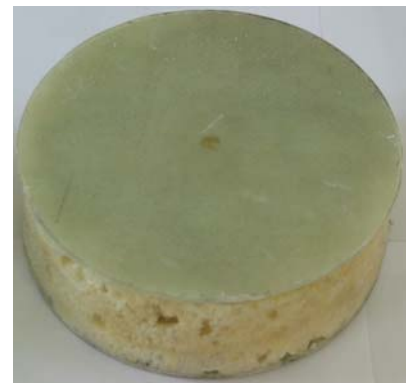
Rys. 5. Obiekt 3 - Panel energochłonny w postaci czterech tulejek kompozytowych z wypełnieniem pianowym
