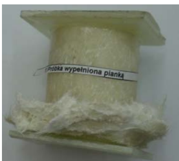
Rys. 14. Sposób deformacji tulejki kompozytowej z wypełnieniem pianowym
