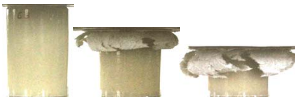
Rys. 9. Sposób niszczenia tulejki kompozytowej
