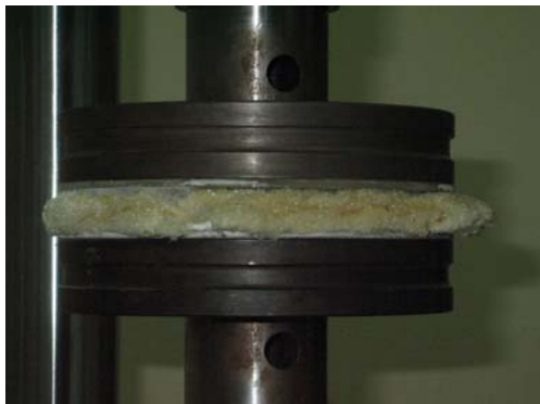
Rys. 18. Sposób niszczenia panelu energochłonnego w postaci czterech tulejek kompozytowych z wypełnieniem pianowym
