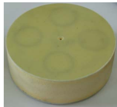
Rys. 6. Obiekt 4 - Panel energochłonny w postaci czterech tulejek kompozytowych z wypełnieniem pianowym
