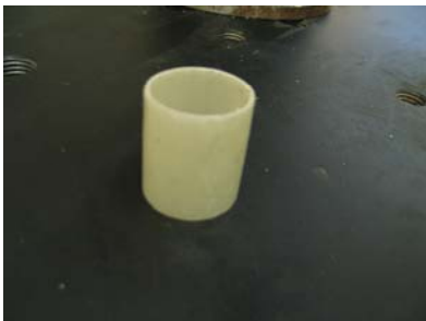
Rys. 2. Obiekt 1 – tulejka kompozytowa wykonana z maty szklanej epoksyd E53
