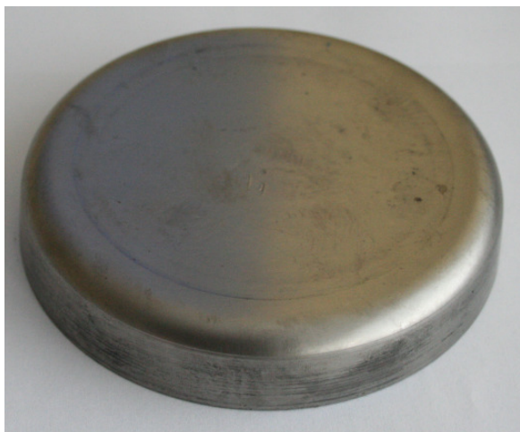
Rys. 4. Wytłoczka ze stopu niklu Inconel 652 wytłaczana ze współczynnikiem m \cong 0,85
