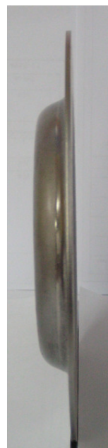
Rys. 5. Wytłoczka ze stopu niklu Inconel 625 wytłaczana ze współczynnikiem m \cong 0,61
