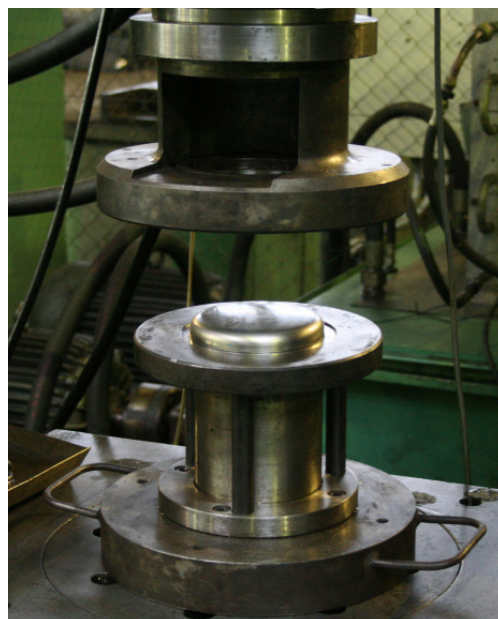
Rys. 1. Tłocznik doświadczalny zamontowany na prasie hydromechanicznej typu PHP ZD-63
