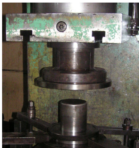
Rys. 2. Tłocznik doświadczalny zamontowany na prasie hydraulicznej typ PYE-250
