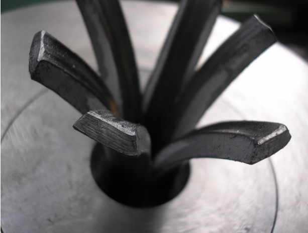
Fot. 4. Całkowite rozdzielenie boków sześciokąta spowodowane pęknięciem przy kształtowaniu sześciokąta na końcówce rury gorącowałcowanej
