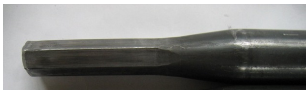
Rys. 2 Rura stalowa gorącowałcowana o średnicy \phi 38,1 mm przeformowana na sześciokąt o wymiarze 22,2 mm.
