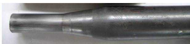
Rys. 3. Rura stalowa gorącowałcowana o średnicy \phi 48,3 mm przeformowana na średnicę \phi 27,4 mm
