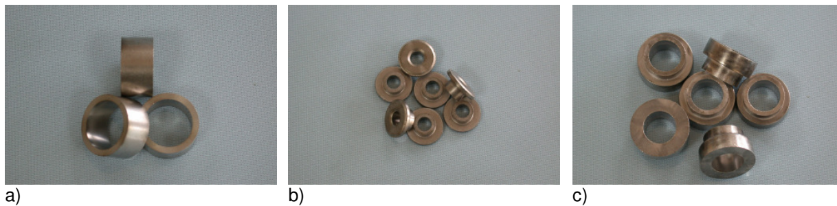
Rys. 4. Części wytwarzane w jednej operacji kształtowania plastycznego: a) pouzdro, b) spacer blade, c) dystanziale
