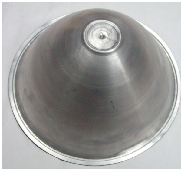
Rys. 4. Wytłoczka cienkościenna o kształcie parabolicznym
