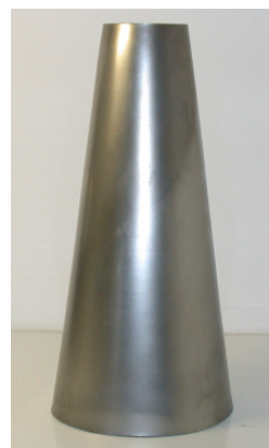
Rys. 6. Wytłoczka wykonana technologią zgniatacia obrotowego z krążka z blachy ze stali kwasoodpornej w gatunku 0H18N9
