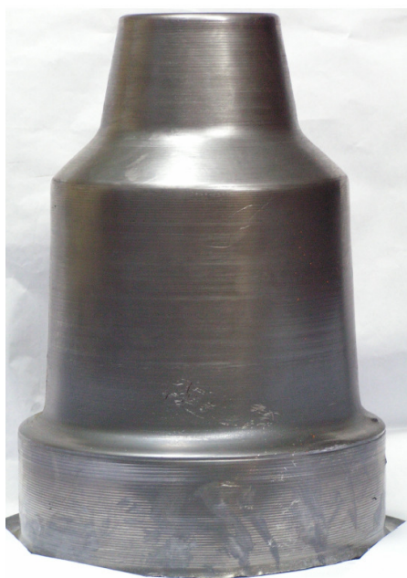
Rys. 3. Wyrób wykonany technologią wyoblania z blachy stalowej
