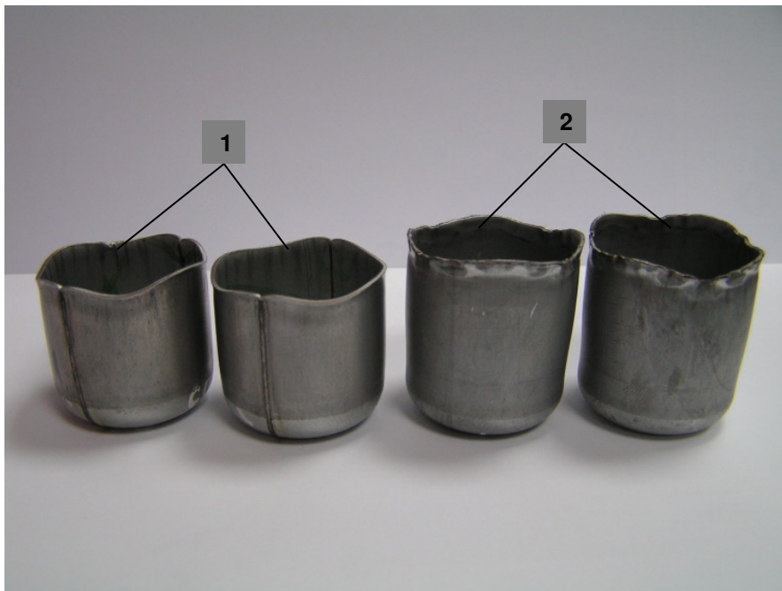
Rys. 1. Wytłoczki wykonane z krążków o średnicy D = 70 mm 1 – z krążków łączonych, 2 – z krążków niezgrzewanych
