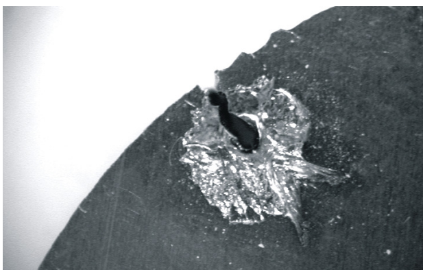
Rys. 8. „Wulkan” powstały podczas wpalania się wiązki laserowej (w wyniku trudności z przepaleniem blachy) Fig. 8. "Volcano" created while the laser beam was burning in
