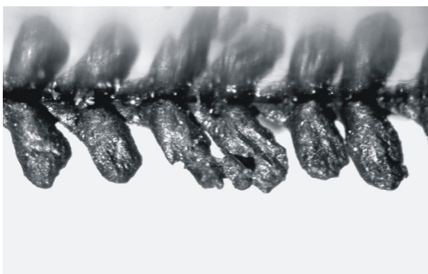
Rys. 12. Nawis metalowy w dużym powiększeniu
