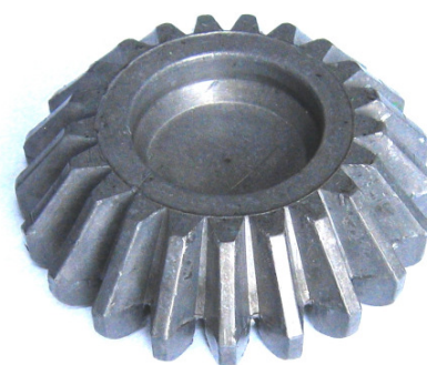
Rys. 3. Końcowy kształt odkuwki: a – otrzymany w wyniku symulacji metodą elementów skończonych (naniesiona siatka MES, kucie bez wypływki), b – fotografia podobnej odkuwki (z wypływką)
