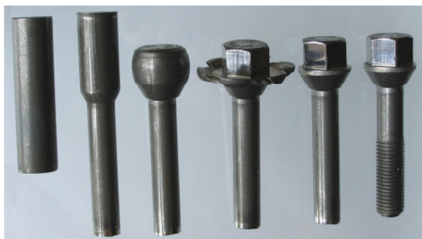
Rys. 7. Technologia kucia śrub sześciokątnych Fig. 7. Hexagon-head bolts forging technology
