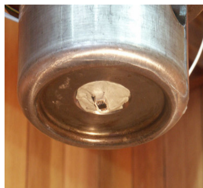
Rys. 2. Miejsce usytuowania magnetorezystora w dnie stempla
