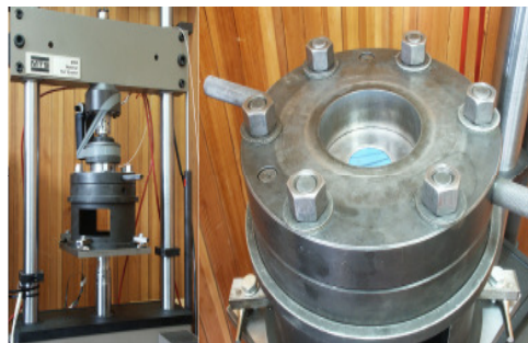
Rys. 1. Maszyna MTS 810 oraz zastosowany przyrząd do tłoczenia
