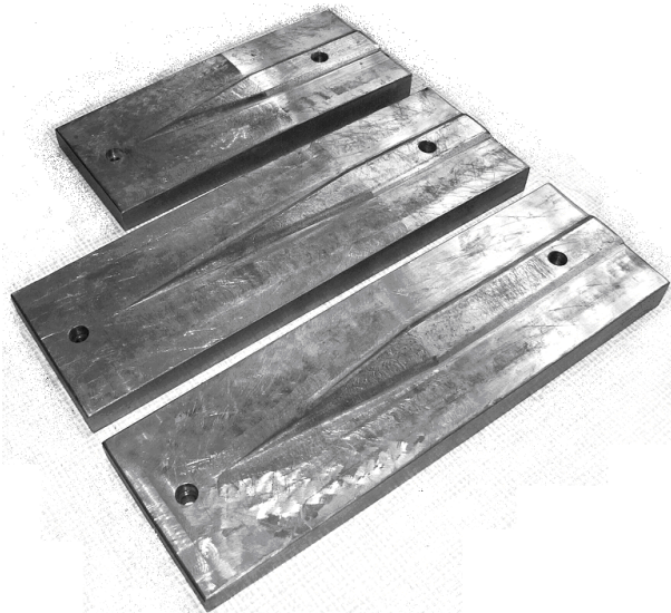
Rys. 4. Niektóre z klinów stosowanych w badaniach eksperymentalnych procesów WKR na rolkach profilowych
