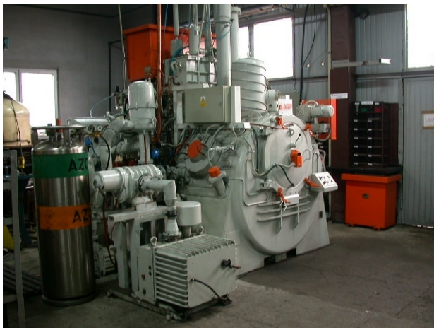
Rys. 1. Zmodernizowany piec RVFOQ-224 w hartowni Pracowni Obróbki Ciepłej Instytutu
