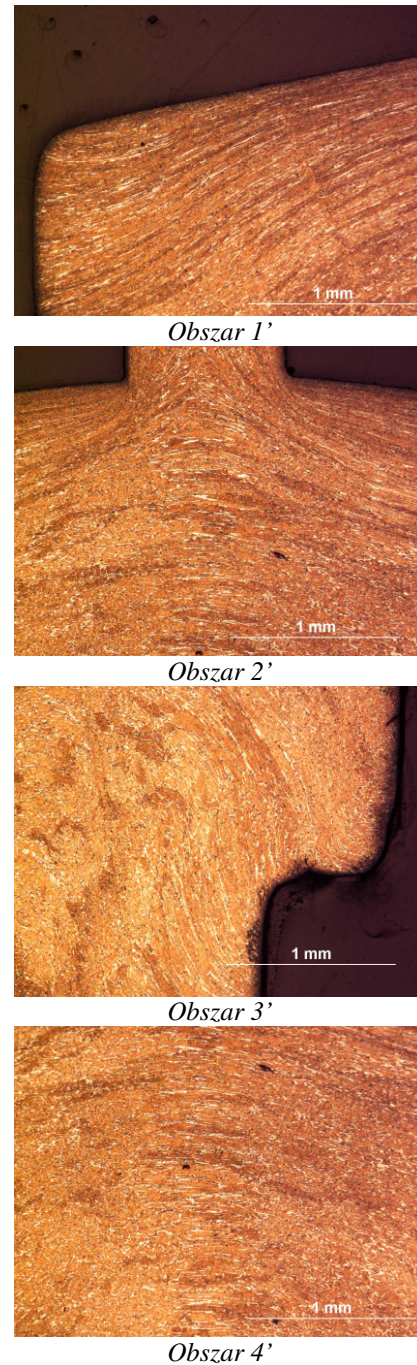
Rys. 11. Mikrostruktura odkuwki ze stopu aluminium PA2
