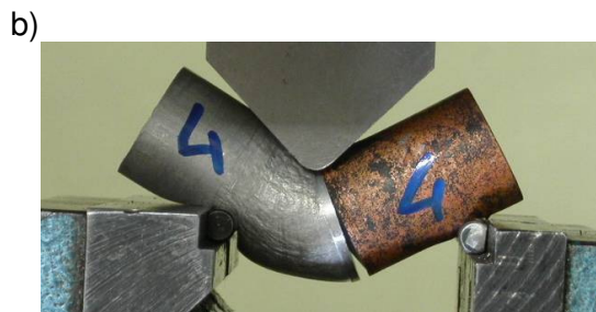
Rys. 5. Przykłady końcowego etapu gięcia próbek wyżarzonych: a) brak pęknięć, b) pęknięcie w złączu
