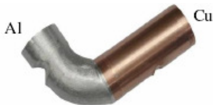
Rys. 18. Próbka Al-Cu użyta do badań strukturalnych złącza niepełniętego; próbka niewyżarzona przed próbą gięcia
