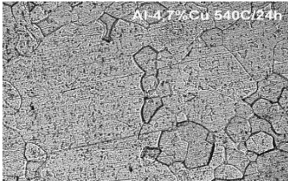
Rys. 4. Struktura po wygrzewaniu 24 h w 540 °C. Pow. 100x
