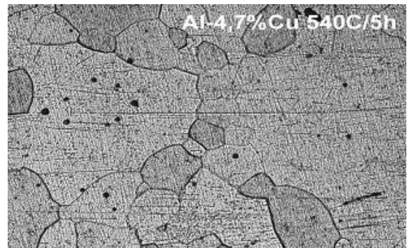
Rys. 3. Struktura po wygrzewaniu 5 h w 540 °C. Pow. 100x
