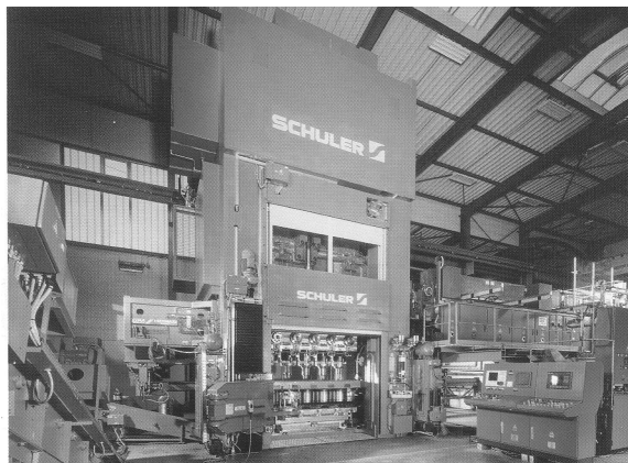
Rys. 12. Prasa wielostopniowa z urządzeniem grzewczym i przenośnikiem do chłodzenia odkuwek [17]
