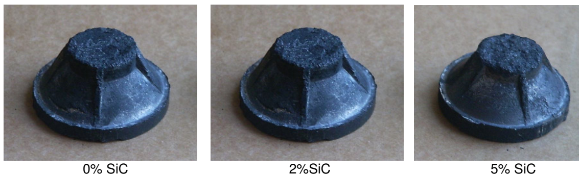
Rys. 8. Odkuwki korka z występami otrzymane w wyniku kucia z udziałem fazy ciekłej w matrycach zamkniętych, wyprasek z proszku stopu \text{AM75} i kompozytów na jego osnowie, w temperaturze 500\text{ }^{\circ}\text{C}
