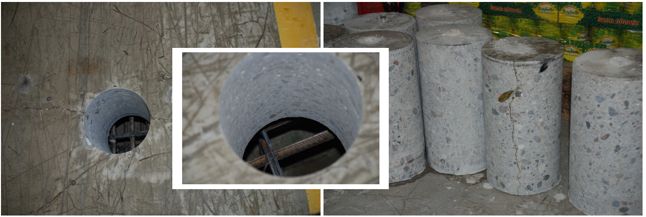
Rys. 9. Odwierty rdzeniowe płyty zbiornika. Próbkę przygotowane do badań w maszynie wytrzymałościowej
