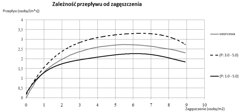
Rys. 7 Wykres 1: Przepływ/zagęszczenie dla różnych stref interpersonalnych Fig. 7 Plot 1: Flow/density for different proxemic spaces
