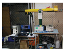
Rys.2. Widok modelu przenośnika zgrzeblowego rurowego z układem pomiarowo-rejestrującym
