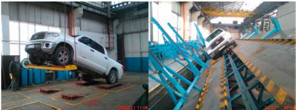
Rys. 1. Toyota Tundra przed przebudową. Wyznaczenie położenia środka masy samochodu wykonane w Przemysłowym Instytucie Motoryzacji [2]
