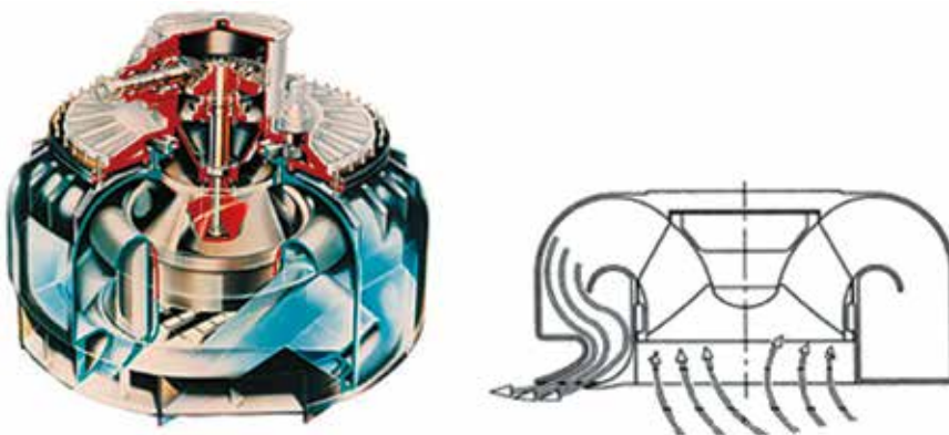
Rys. 7. Pędnik Pump-Jet firmy Schottel – przekrój z kierunkiem przepływu wody [5]
