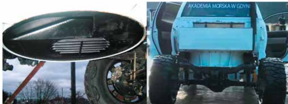
Rys. 8. Pędnik Pump-Jet firmy Schottel zainstalowany w pojeździe za tylną osią
