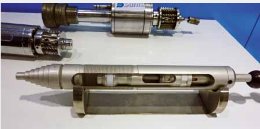
Ryc. 8. Brazylijski Sanit, urządzenia do dynamicznego Berstlingu i natrysku epoksydowego przewodów wodociągowych
