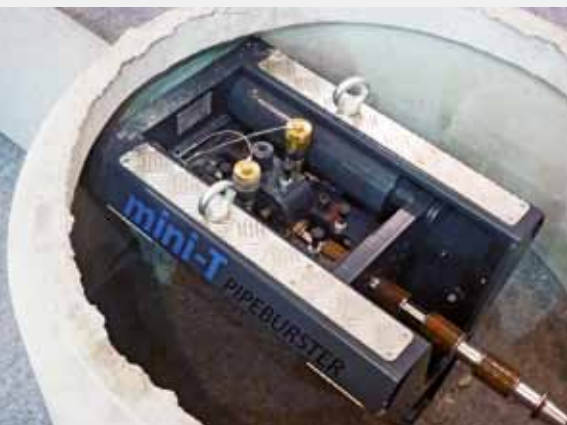
Ryc. 5. Mini-T Pipeburster do bezwykopowej wymiany podziemnych przewodów
