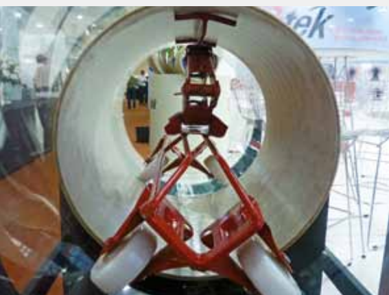
Ryc. 7. Brazylijski O-tek z urządzeniem do transportu krótkich modułów rur
