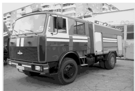
Рис. 2. Пожарные автоцистерны с емкостью для воды 2 и 5 куб. М
