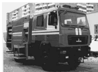
Рис. 3, 4. Пожарные автоцистерны с емкостью для воды 5 и 5,8 куб. м
