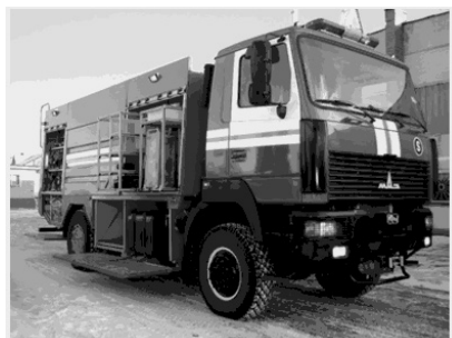
Рис. 3, 4. Пожарные автоцистерны с емкостью для воды 5 и 5,8 куб. м
