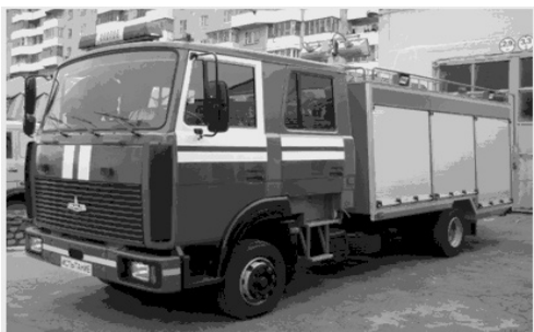
Рис. 1. Автомобиль быстрого реагирования АБР-0,4/130 на шасси МАЗ 437041
