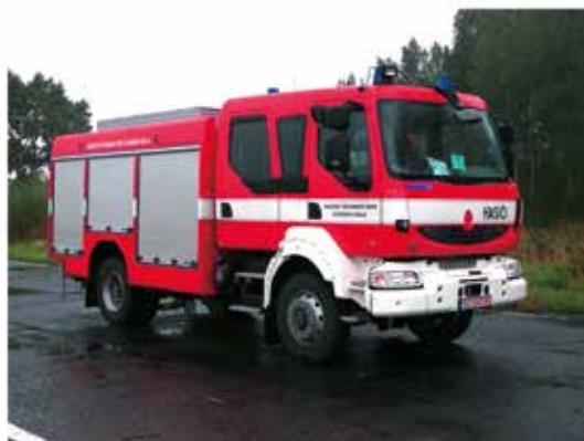
Rys. 2. Samochód pożarniczy o masie 12 ton i wysoko położonym środku ciężkości
