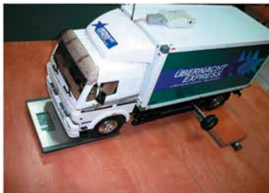
Rys.9. Wyznaczanie środka masy metodą ważenia nacisków osi
