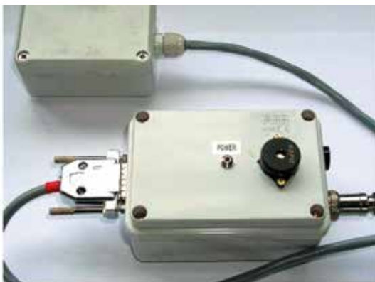
Rys.3. Układ do sygnalizacji zagrożenia przewróceniem samochodu
