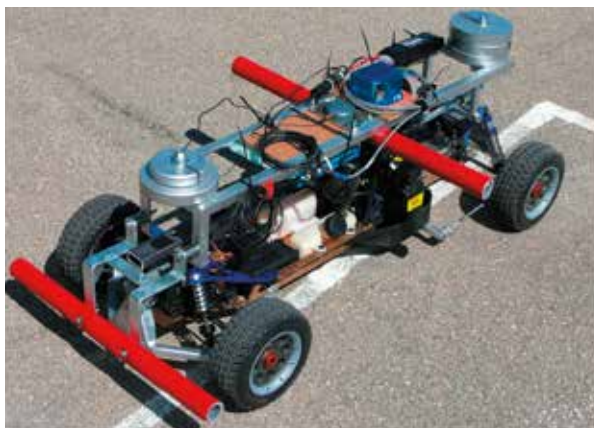
Rys.13. Widok stanowiska sterowniczego mobilnego modelu samochodu dla sterowania z kontaktem wzrokowym, zabudowany na podeście
