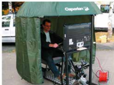
Rys.12. Widok stanowiska sterowniczego mobilnego modelu samochodu. Po lewej dla sterowania z kontaktem wzrokowym, po prawej dla sterowania z obrazu na monitorze
