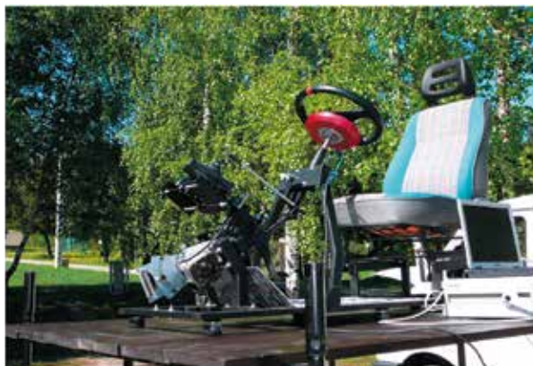
Rys.13. Widok stanowiska sterowniczego mobilnego modelu samochodu dla sterowania z kontaktem wzrokowym, zabudowany na podeście
