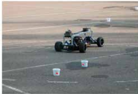
Rys.11. Widok mobilnego modelu badawczego z obciążnikami i kamerą teletransmisji obrazu do stanowiska sterowniczego
