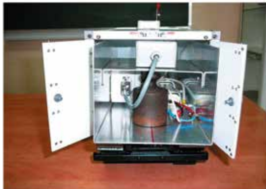
Rys.8. Umieszczenie pojemnika w nadwoziu samochodu
