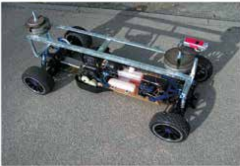
Rys.11. Widok mobilnego modelu badawczego z obciążnikami i kamerą teletransmisji obrazu do stanowiska sterowniczego
