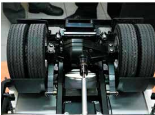
Rys.6. Widok mostu tylnego zawieszzonego na resorach wielopiórowych
