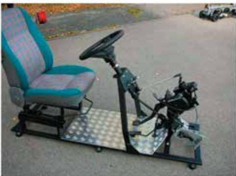
Rys.12. Widok stanowiska sterowniczego mobilnego modelu samochodu. Po lewej dla sterowania z kontaktem wzrokowym, po prawej dla sterowania z obrazu na monitorze
