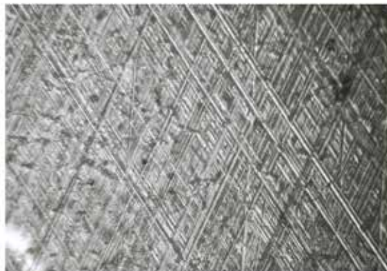
Rys.2. Powierzchnia tulei cylindrowej po honowaniu (powiększenie 100)
