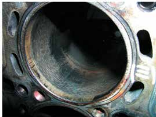
Rys.4. Tuleja cylindrowa z widocznymi rowkami wykonanymi za pomocą lasera
