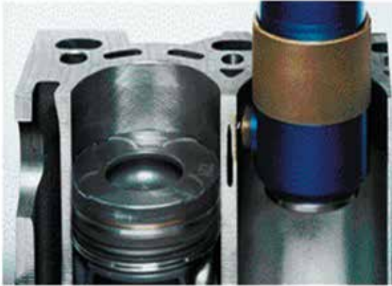
Rys.3. Głowica laserowa w trakcie wykonywania zasobników oleju w górnej części tulei cylindrowej [3]
