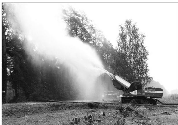
Рис.6. Мобильный комплекс пожаротушения тяжелого класса, оснащенный дистанционно-управляемой реактивной установкой газо-водяного тушения.
