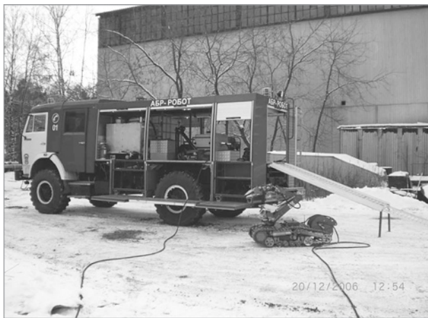
Рис.2. Мобильный робототехнический комплекс разведки и пожаротушения легкого класса МРК-РП Fig. 2. Mobile exploration and extinguishing robotic system the light class MRK-RP
