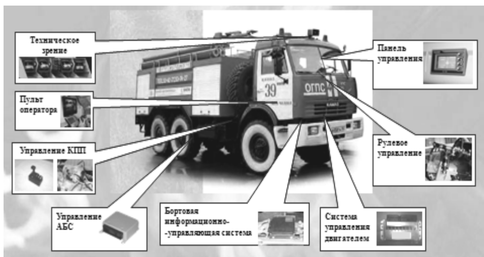
Рис.10 Дистанционно-управляемый пожарно-спасательный автомобиль Fig. 10. Remotely controlled firefighting and rescue vehicle
