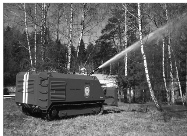
Рис.5. Мобильный противопожарный робот среднего класса ЕЛЬ-4 Fig. 5. Mobile firefighting robot heavy class –EL 10 class –EL4
