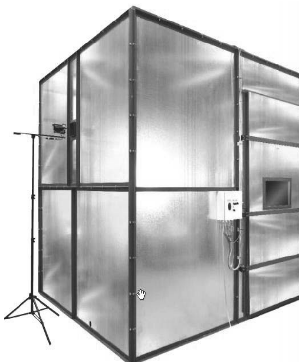
Ryc. 6 Stanowisko badawcze wg PN-EN 61034-1 [18]
