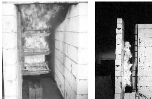
Ryc. 1. Przykład stanowiska do badań w skali rzeczywistej w ułożeniu poziomym i pionowym kabli [3]
