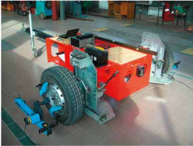
Rys. 6. Przyczepa pomiarowa, regulacja kątów skręcenia i pochylenia kół
