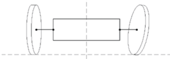
Rys. 3. Schemat niezależnego skręcenia i pochylecia kół przyczepy pomiarowej
