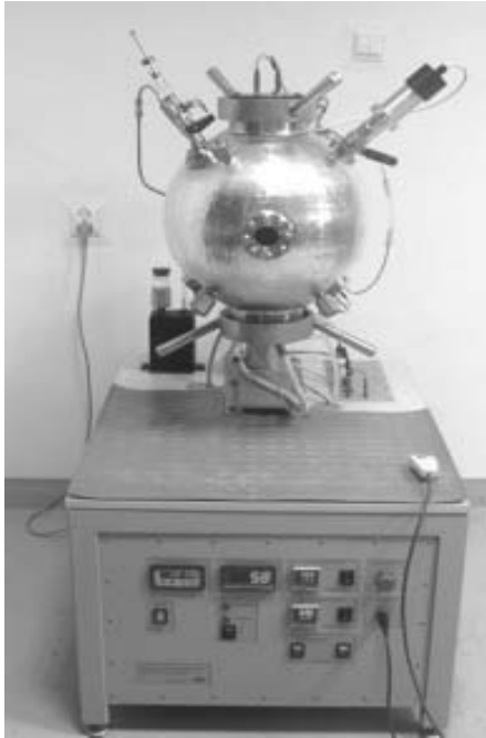
Ryc. 2. Stanowisko do oznaczania stężeniowych granic wybuchowości metodą B o poj. 20 litrów, stosowane w Politechnice Warszawskiej [4].
