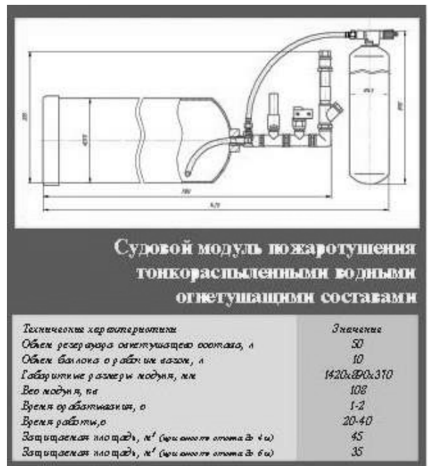
Рис. 17. модуль пожаротушения тонкораспыленными водными огнетушащими составами Fig. 17. Compressor generating streams of mist to extinguish fires utilising water with additives
