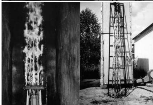
Рис. 7. Испытания кабельной продукции и электротехнических изделий
