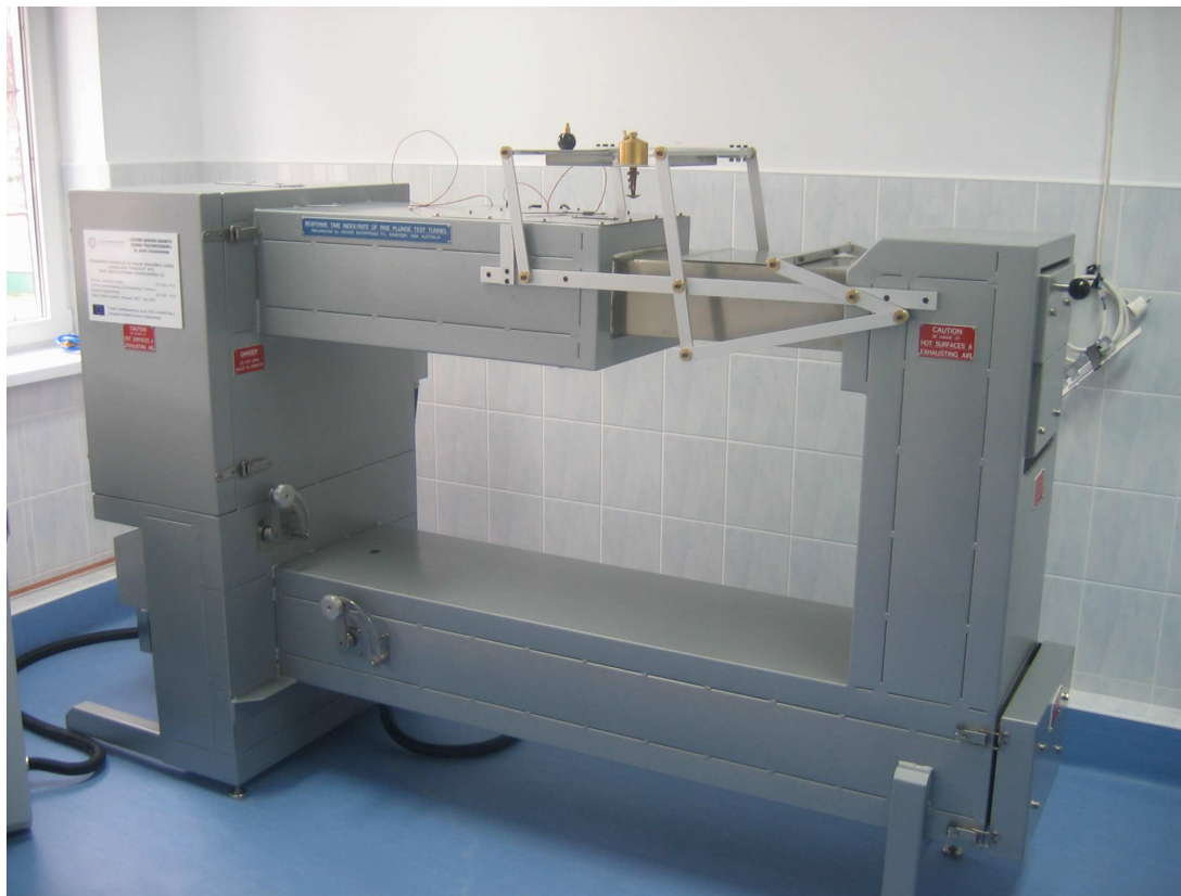
ZDJĘCIE 2 Stanowisko do badania wskaźnika czasu zadziałania tryskaczy [RTI] oraz współczynnika przewodności [C]
