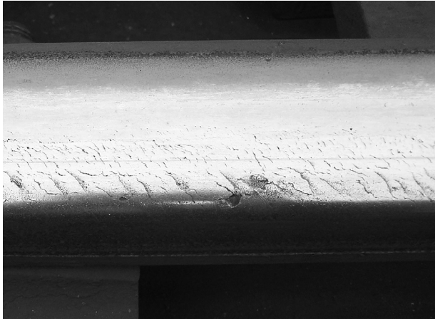
Rys. 10. Rysy na zaokrągleniu główki szyny (wada 2223)
