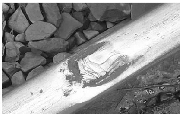
Rys. 9. Wada 227 o charakterystycznym kształcie podkowy
