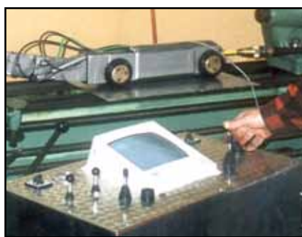
Zdalnie sterowany robot z kamerą zaprojektowany i wykonany całkowicie w warsztatach Remkanu.
