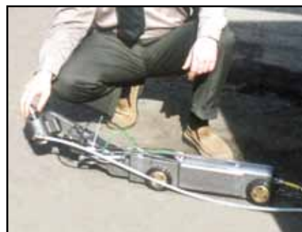
Zdalnie sterowany robot z kamerą zaprojektowany i wykonany całkowicie w warsztatach Remkanu.
