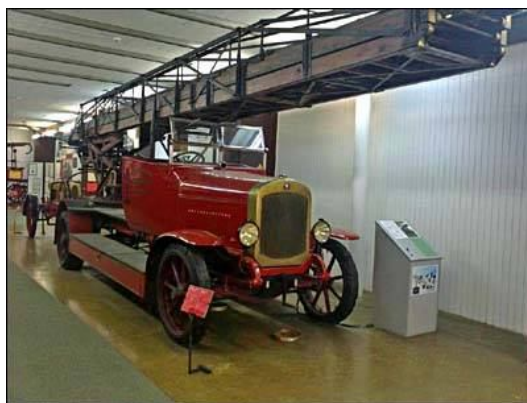
Ryc. 2. Drabina Magirus z 1924 roku o wysokości 20 m, znajdująca się w Muzeum Techniki w Zagrzebiu w Chorwacji [2].
