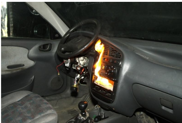
Ryc. 4. Miejsce zainicjowania pożaru.
