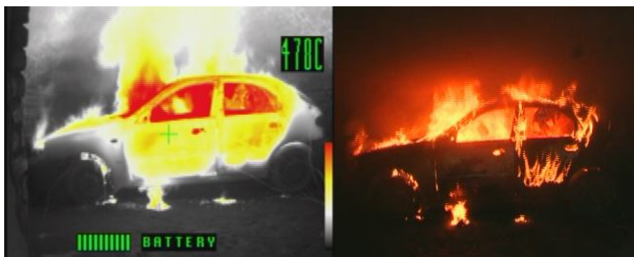
Rys. 5. Termogramu i fotografia samochodu w 27. minucie eksperymentu. Na termogramie krzyżem zaznaczone jest miejsce pomiaru temperatury.
