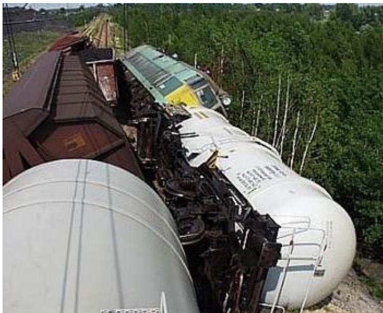
Fot. 1. Wykolejona część składu pociągu [1]
