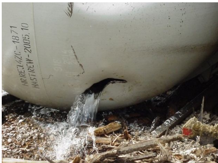
Fot. 3. Miejsce rozszczelnienia cysterny z 1-oktanołem [1].
