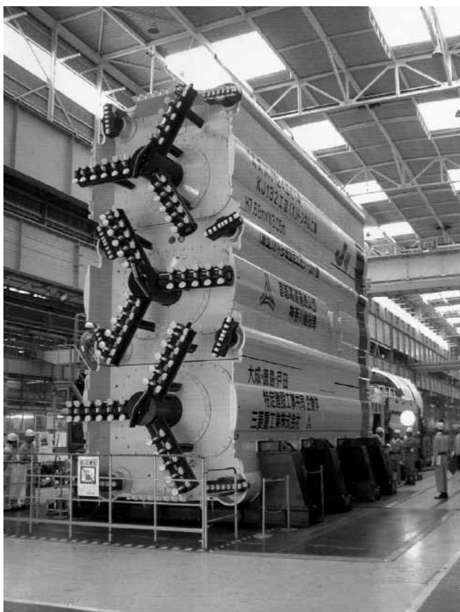
Ryc. 6. Prostokątna tarcza wiertnicza wykorzystana do drążenia obudowy tunelu Trans-Kawasaki Expressway Route
