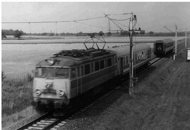
Rys. 5. Badania ruchowe hamulca z odczepianiem wagonu w ruchu (fot. Z. Cichocki)
