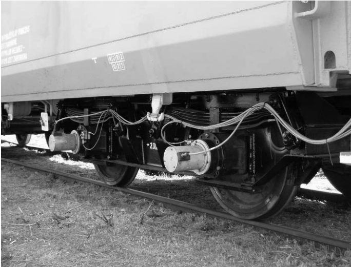
Rys. 11. Zestawy pomiarowe zamontowane w wagonie towarowym
