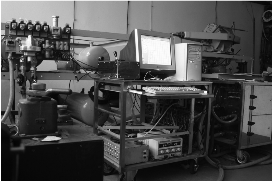
Rys. 4. Stanowisko do badań stacjonarnych hamulca. Badania nadajnika hamulca zespolonego z panelem zaworu maszynisty DAKO BSE
