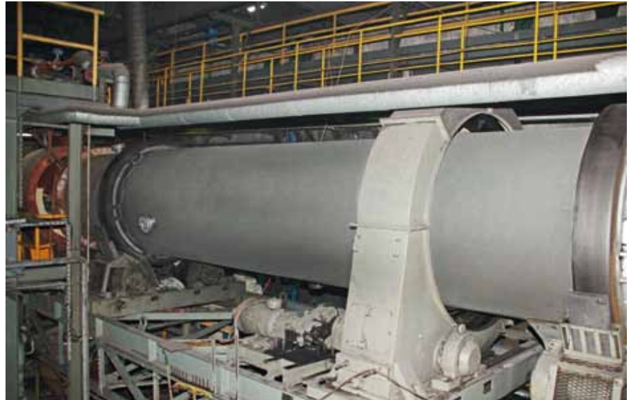
Sekcja oczyszczania spalin (z lewej) i piec obrotowy (z prawej), Stacja Regeneracji Węgla Aktywnych w Imielinie, Górnośląskie Przedsiębiorstwo Wodociągów SA
