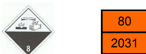
Ryc. 7. Oznakowanie cystern i autocystern - pomarańczowe tablice ostrzegawcze z numerami rozpoznawczymi 80/2031 oraz nalepka ostrzegawcza nr 8 wg RID/ADR.
