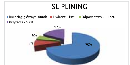
Ryc. 14. Sliplining wykonany pod drogą – procentowy podział kosztów
