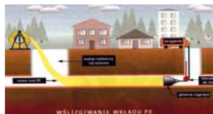
Ryc. 2. Sliplining – technika wykonywania [4]
