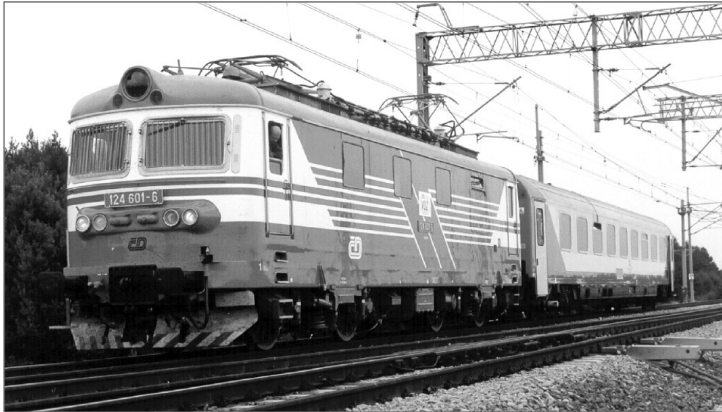
Rys. 4. Pociąg pomiarowy z lokomotywą VUŽ 124 S [5]
