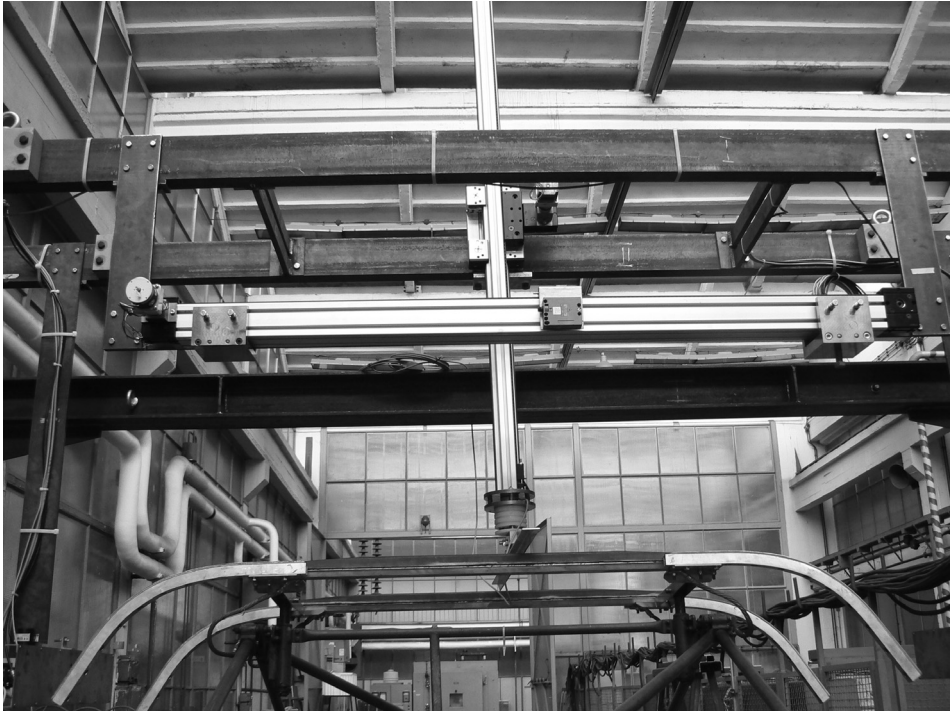
Rys. 12. Stanowisko do badania odbieraków podczas próbnego montażu w Instytucie (fot. M. Kaniewski)
