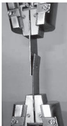
Rys. 6. Połączenie wykonane w technologii „Solid SPR” podczas próby ścinania.
