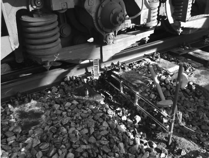
Rys. 12. Pomiary ugięć szyny od obciążeń dynamicznych – odcinek poligonowy II
