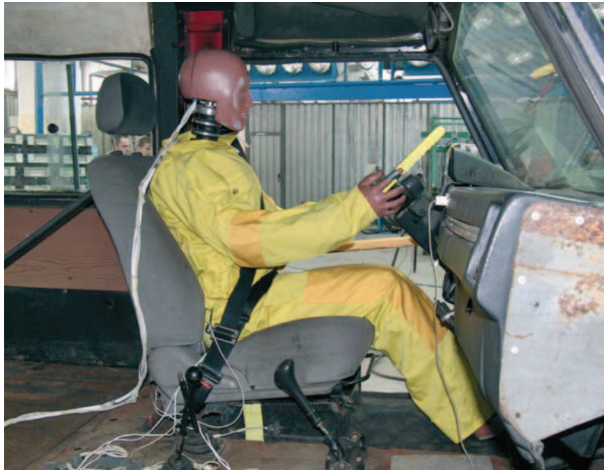
Rys. 2.1. Pozycja manekina z czujnikami w samochodzie
