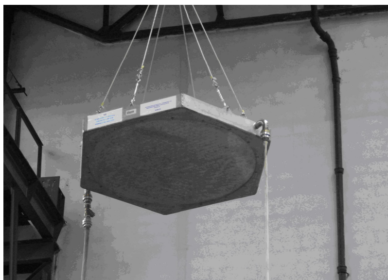
Fot. 5. Pojemnik do wytworzenia sztucznego deszczu
