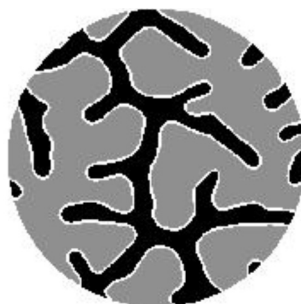
Fot. 6. Przykładowy obraz tarczy testowej, z zaetykietowanymi regionami, reprezentującymi smar (obszary ciemne) oraz powierzchnie bez smaru (obszary jasne)
