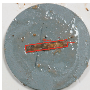
Fot. 35. Szczelina o długości 30 mm i szerokości 5 mm, wypełniona osadem z płuczki potasowo-polimerowej z dodatkiem: wytłoki buraczane, GM8, GM12, GM20, GM30 oraz K2
