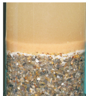
Fot. 6. Osad wytworzony z Mt (0,35÷0,7) + K2, na złoże o uziarnieniu 1÷2 mm
