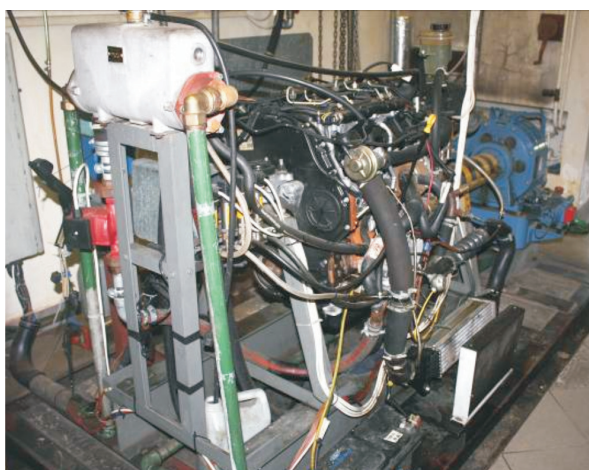
Rys. 2. Stanowisko badawczo-testowe z silnikiem FORD 2.0i 16V Duratorq TDCi
