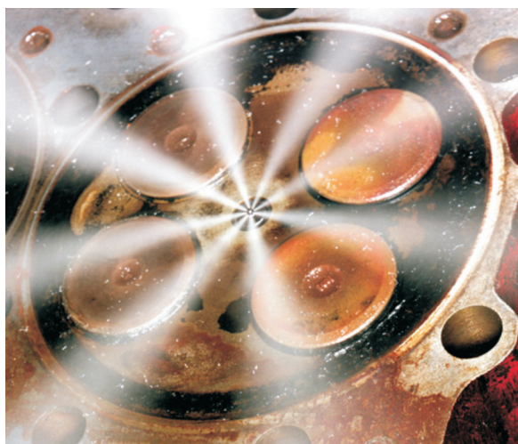
Rys. 1. Ograniczenia wypływu i zniekształcenia strug rozpylanego paliwa na skutek osadów koksowych, tworzących się wewnątrz kanalików i wokół samych otworków wylotowych wtryskiwaczy: a) wtryskiwacz „czysty”, b) wtryskiwacz „zakoksowany” (Lubrizol Corporation)
