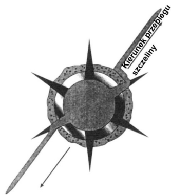
Rys. 3. W szczelinowaniu hydraulicznym szczeliny nie zawsze stanowią przedłużenie kanałów perforacyjnych [12]
